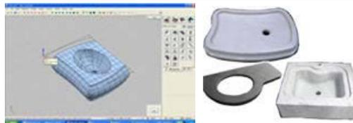
**F-AUTOM-23** ERWEITERUNG ZUR "VEREINFACHUNG" DER TOUCH SOFTWARE FÜR DAS ABSENKEN VON FINGERFRÄSERN / HOHLBOHRERN / DIAMANTTRENNSCHEIBEN ZYKLUS MANAGEMENT ZUR REALISIERUNG VON ABFLUSSLÖCHERN UND ECKEN
